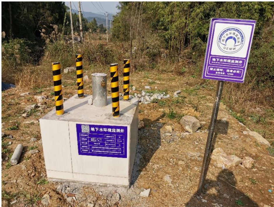
图3-2 站场北侧1#地下水跟踪监测井
